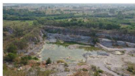
บริเวณจุดต่ำสุดที่เป็นบ่อรับน้ำ (Sump)
